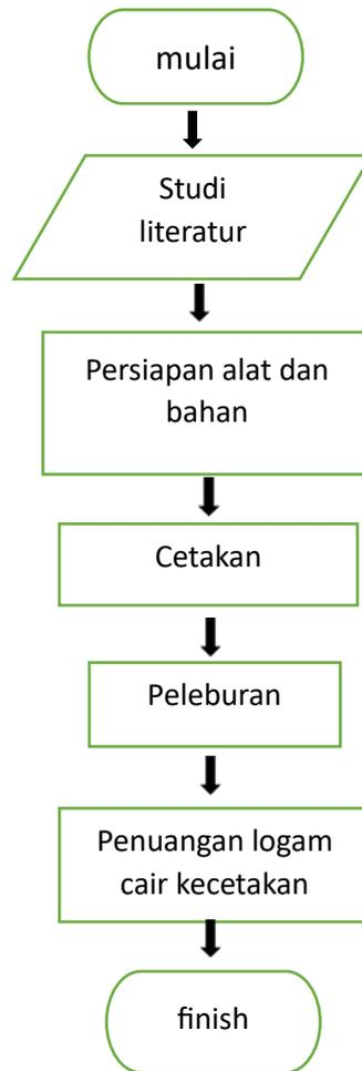
**Gambar 3.** Diagram alir proses pengecoran logam
