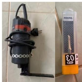
**Gambar 3.** Mesin Router dan Mata Router
