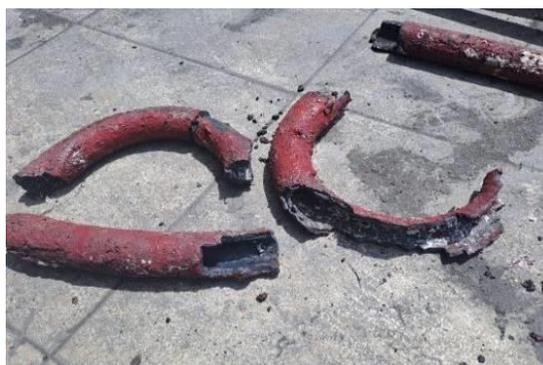
**Gambar 3.** Tube yang telah mengalami *overheating*
