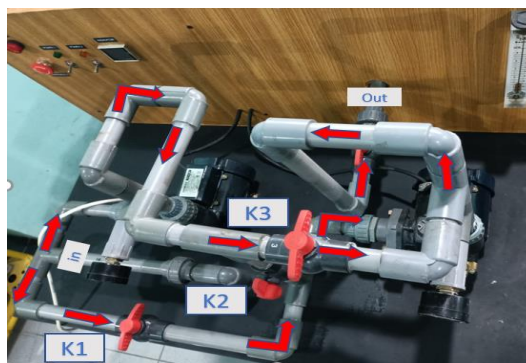
Gambar 11. Susunan instalasi pompa paralel
