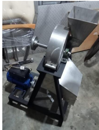
Gambar 2. Mesin pengiris bawang
