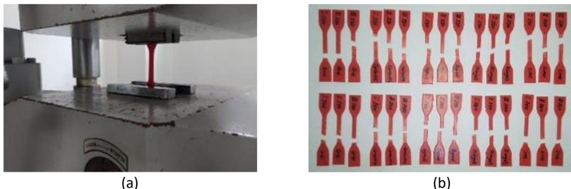
**Gambar 7.** Proses pengujian tarik (a) dan spesimen yang telah diuji tarik (b)
