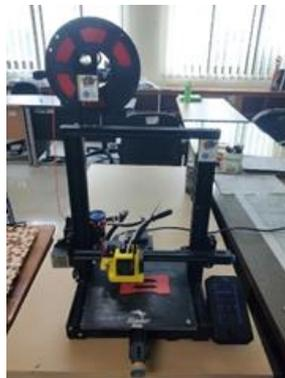
**Gambar 5.** Pencetakan spesimen menggunakan Printer 3D jenis FDM dengan filamen ABS
