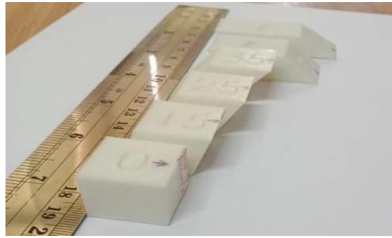
Gambar 7. Spesimen Hasil Cetak 3D Printer
