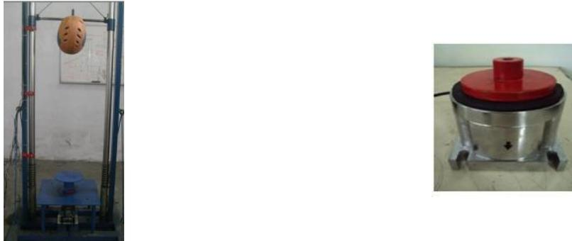
**Gambar 5.** (a). Alat uji impak jatuh bebas dan (b). Alat pengukur energi dan gaya impak(Loadcell)
