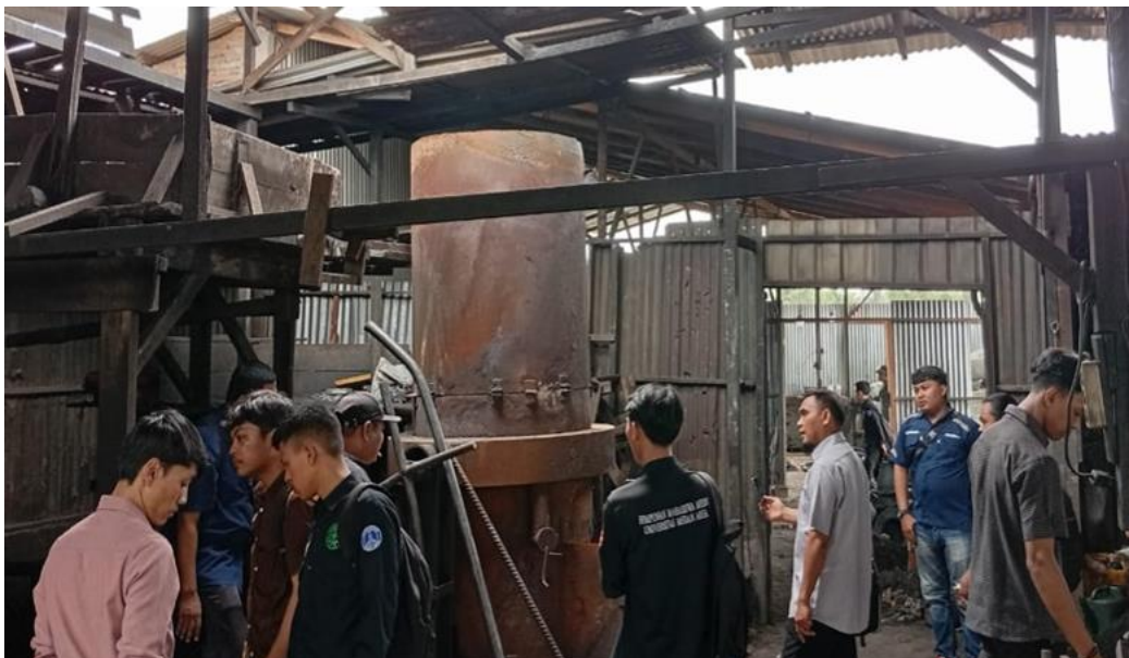
Gambar 4. Dapur peleburan baja cor kelabu (Tanur). Kegiatan ini merupakan kegiatan pembelajaran langsung meninjau ke lapangan, agar mahasiswa mendapatkan pengalaman langsung dari praktisi dunia industri
