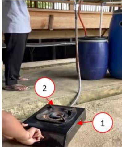
Gambar 3. Uji coba nyala api berbahan bakar biogas dari kotoran domba
