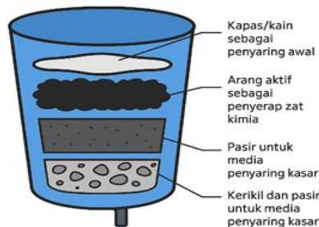
**Gambar 2.** Rancangan alat filtrasi air sederhana dan media isian
