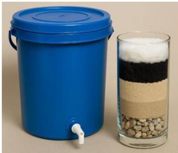
**Gambar 1.** Alat filtrasi air sederhana dan media isian
