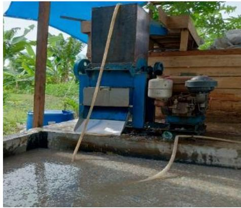
**Gambar 1.** Mesin Pencacah plastik
