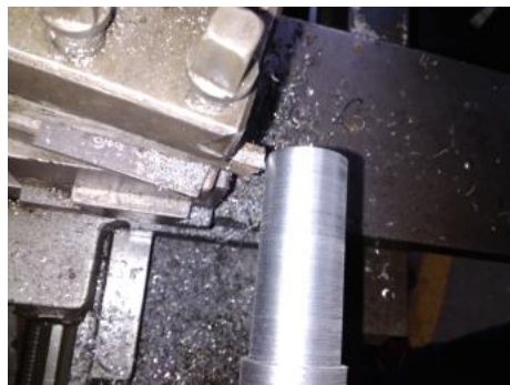
Gambar 15. Hasil pemakanan dengan kecepatan 500 rpm dan bentuk chips
