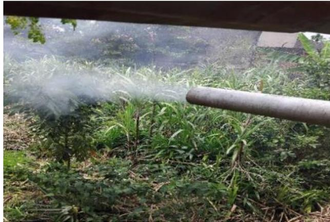
**Gambar 7.** Opasitas menggunakan *wet scrubber* dengan 2 sprinkler
