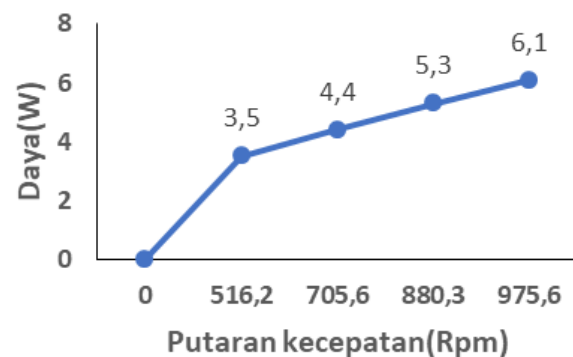
Gambar 7. Grafik hubungan rpm terhadap daya
