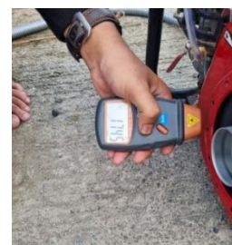
Gambar 10. Pengukuran kecepatan putar pada mesin saat dilakukan pengujian
