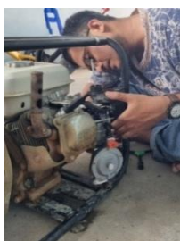
Gambar 9. Proses pemasangan konverter kit pada mesin
