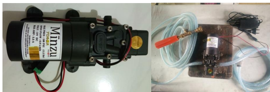
Gambar 13. Pompa air motor DC 12V dan rakitannya
