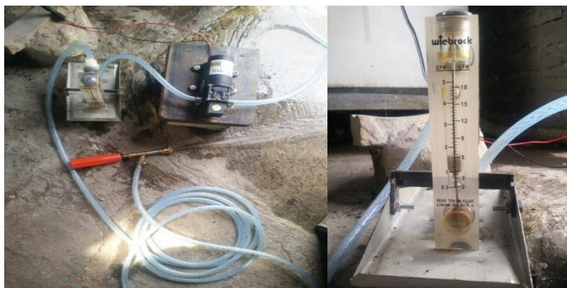
Gambar 15. Proses pengujian tekanan semprot dengan alat flow meter
